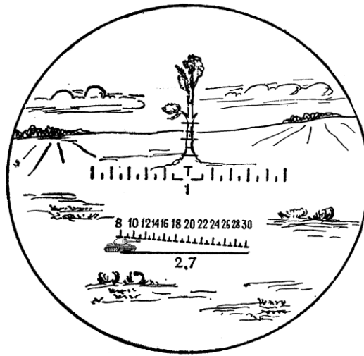
Рис. 56. Визначення відстані до цілі висотою 2,7 м за допомогою далекомірної шкали (відстань до танка 800 м)
